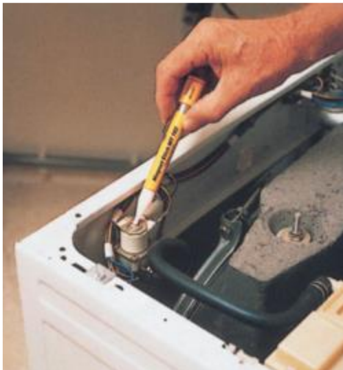
Rys. 6.7. Sprawdzanie pola elektromagnetycznego cewki przekaźnika
