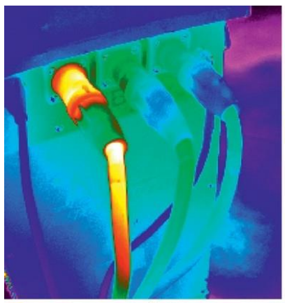
Rys. 6.9. Uszkodzone połączenie wtykowe
