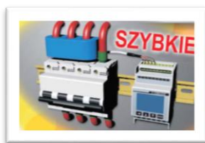
Rys. 6.6. Sposób montażu rejestratora
