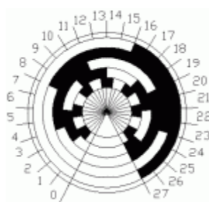
Rys. 1.6. Przetwornik obrotowy z kodowaniem Gray'a
