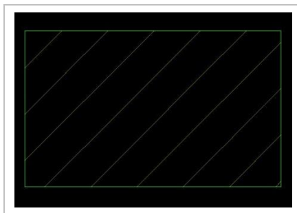
Rysunek 4.10. Przykład kreskowania Źródło: GstarCAD 2012 Podręcznik Użytkownika s. 43
