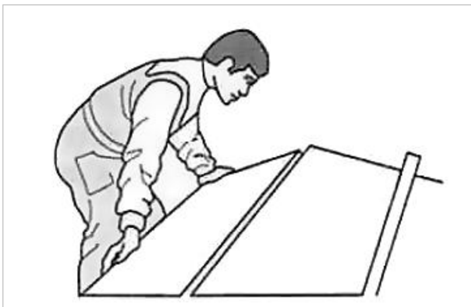
Rysunek 1.2 Łamanie pociętej płyty gipsowo-kartonowej
