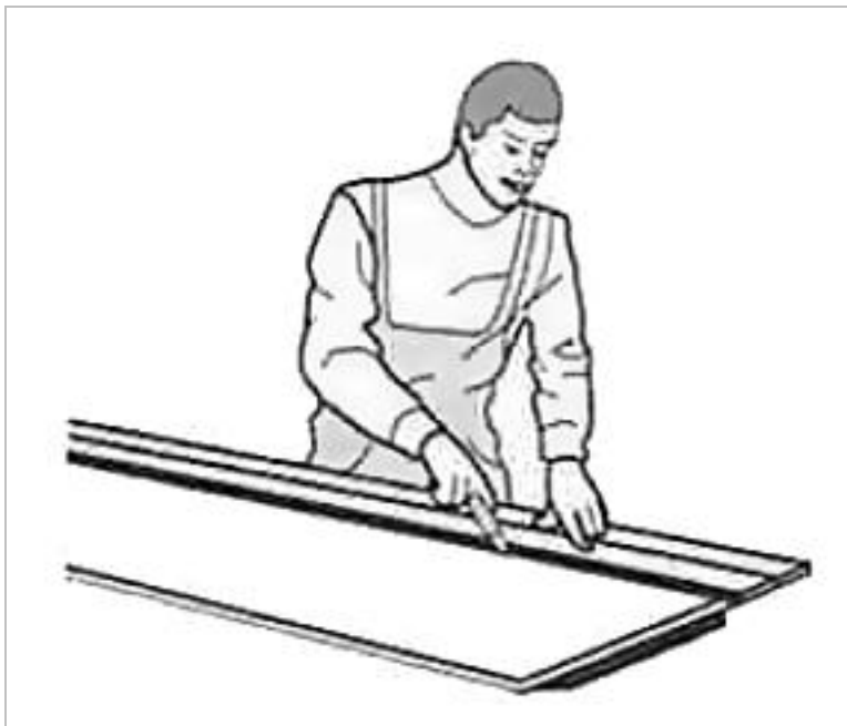
Rysunek 1.1 Nacinanie nożem płyty gipsowo-kartonowej
