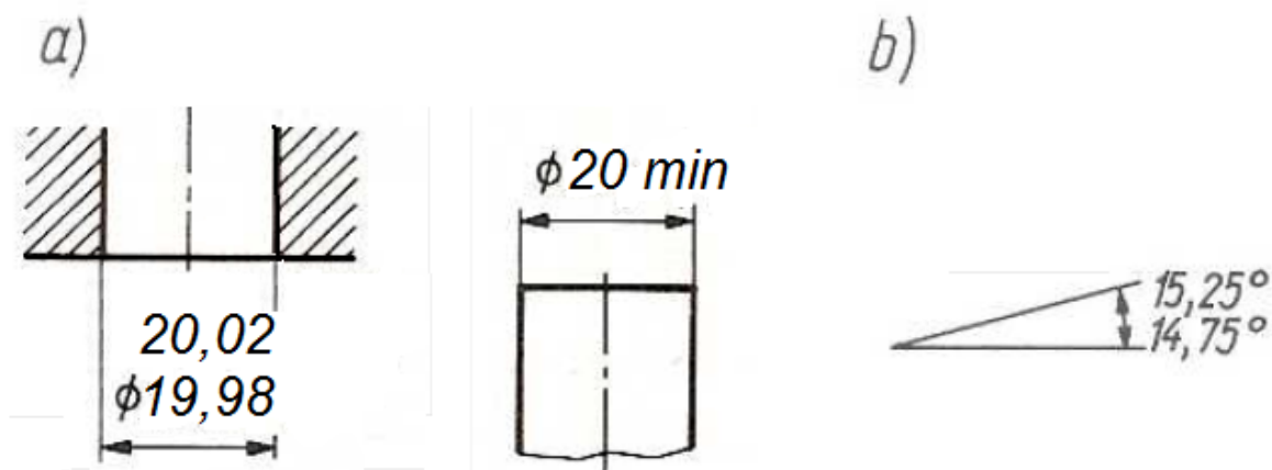
Rys. 3.12. Tolerowanie wymiarami granicznymi dla wymiarów a) liniowych, b) kątowych
