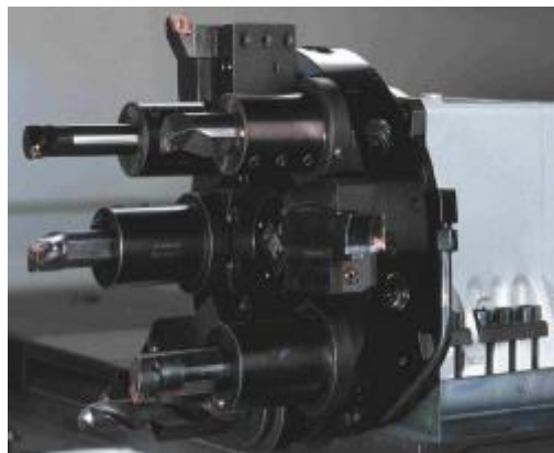
Rys. 7.9. Widok głowicy rewolwerowej tokarki CNC [System ZERO-OSN]
