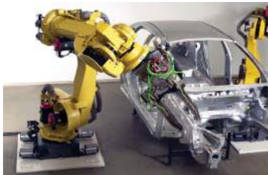
Rys. 7.23. Zrobotyzowana linia zgrzewania karoserii samochodowych [Biuletyn automatyki nr 3/2004; Astor]
