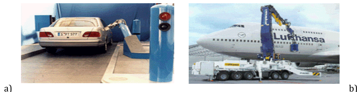
Rys. 7.29. Roboty usługowe: a) do tankowania samochodów, b) do mycia samolotów [ www.robotyka.pl : teoria robotyki]
